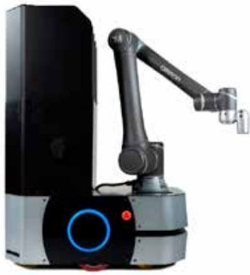
Bild6 Mobile Manipulator LD250 arm.
